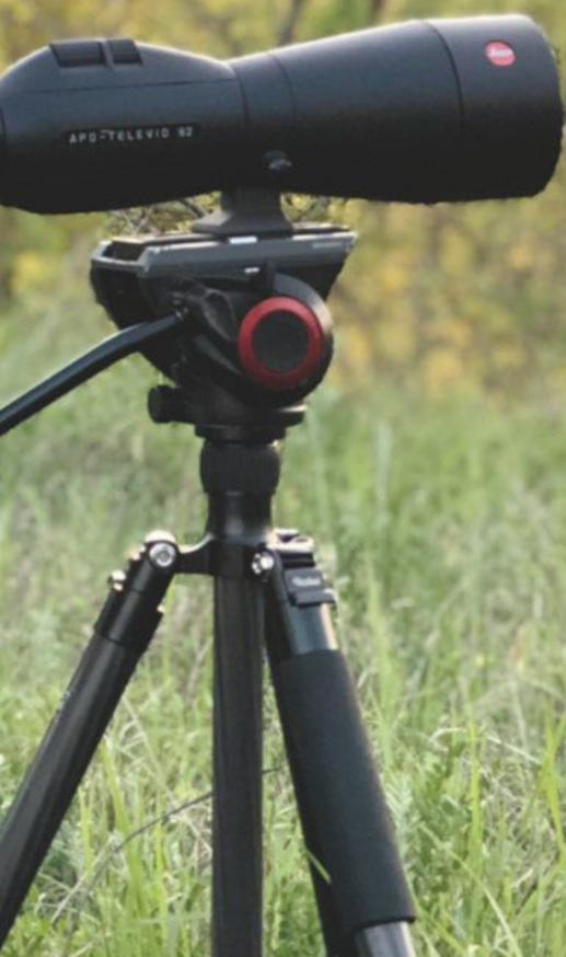
Il termine tecnico è “digiscoping”, ovvero la fotografia – e la videoripresa – ottenute con una foto o video camera associate ad un cannocchiale da osservazione. Anni fa si praticava con la fotocamera compatta o con la reflex, usando adattatori più o meno stabili, e i fotografi più esigenti usano tuttora la macchina reflex (o le nuove mirrorless) per ottenere risultati eccezionali.
