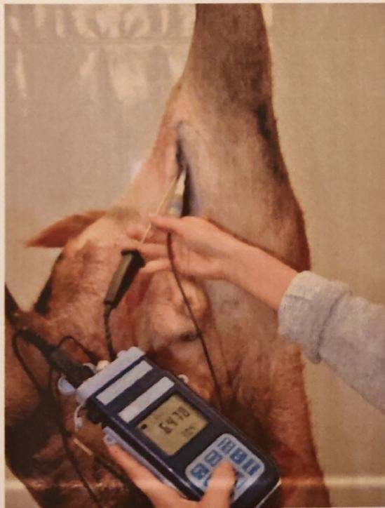
Figura 1: Misurazione del pH su carcassa di cervo. Oltre allo strumento si nota la sonda di misurazione del pH e la sonda termometrica.
