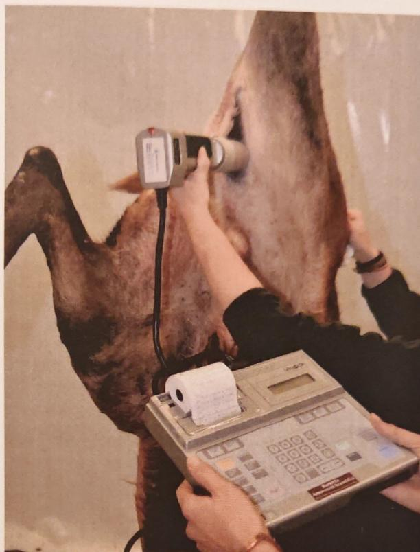
Figura 2: Misurazione di luminosità, indice di rosso e indice di giallo mediante l'utilizzo di un colorimetro su carcassa di cervo.
