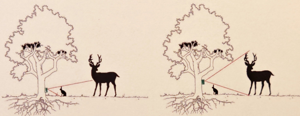
Fig. 14- Different risultato in base all'altezza di posizionamento della fototrappola.
