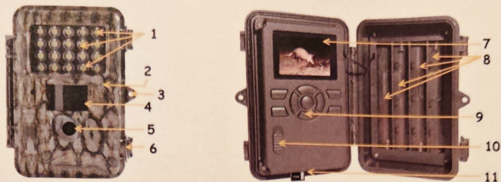
Fig. 12- Descrizione delle principali componenti di una fototrappola: (1) flash; (2) luce per testare il sensore di movimento; (3) foro per lucchetto di sicurezza; (4) sensore a infrarossi passivo (PIR); (5) obbiettivo della fotocamera; (6) leva di chiusura; (7) schermo per visualizzare il menu impostazioni; (8) vano per le batterie (AA); (9) tasti del menu; (10) interruttore di accensione; (11) slot per scheda SD. Fonte: http://www.cameratrap.co.za
