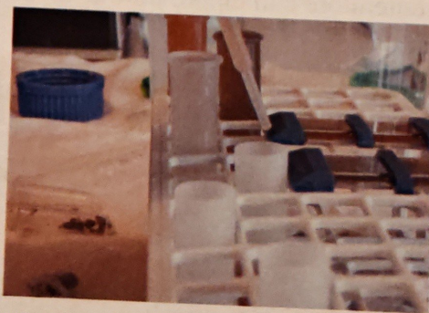
Figura 23: Riempimento delle provette per la flottazione.
